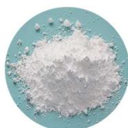
L'allumina tri-idrata è una carica inerte, di elevata purezza, particolarmente utilizzata come ritardante di fiamma in sistemi termoindurenti ed elastomeri. Basso contenuto di acqua, facilmente lavorabile, diminuisce i ritiri dimensionali e il calore di reazione.
